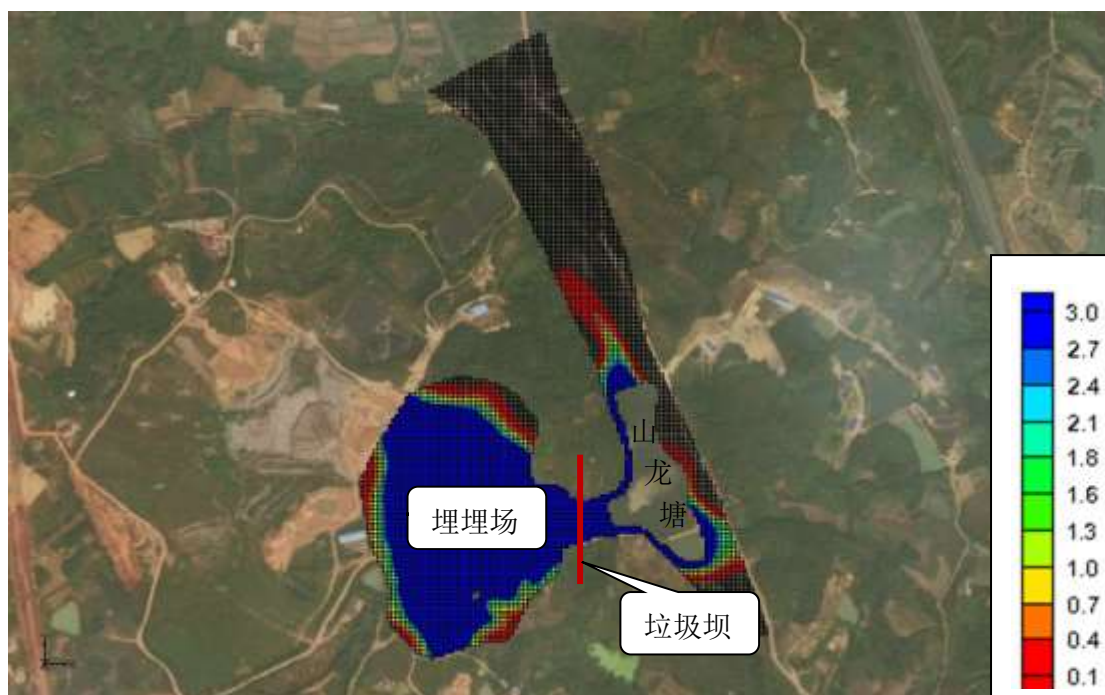
图 6.2-24 渗滤液渗露后 1000 天，第二层含水层 \text{COD}_{\text{Mn}} 浓度增量分布图
