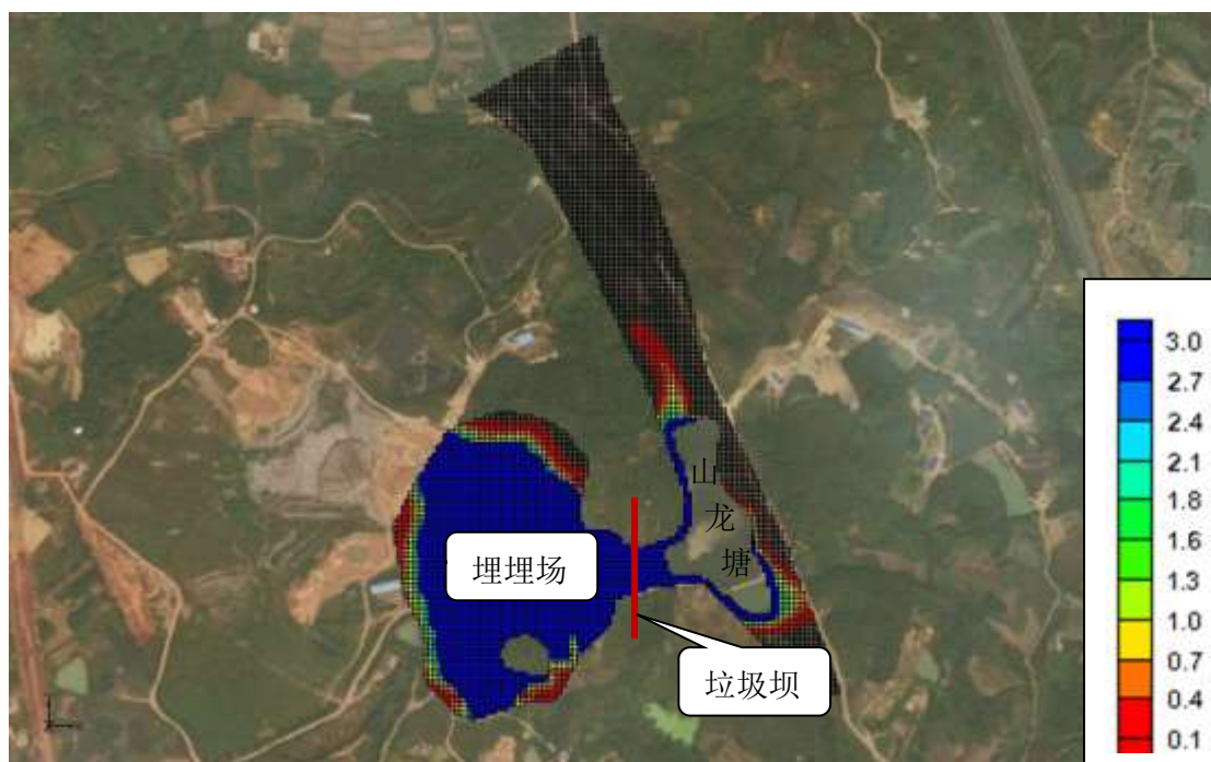
图 6.2-20 渗滤液渗露后 7300 天，第一层含水层 \text{COD}_{\text{Mn}} 浓度增量分布图
