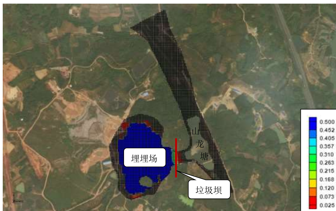
图 6.2-29 渗滤液渗露后 100 天，第一层含水层氨氮浓度增量分布图
