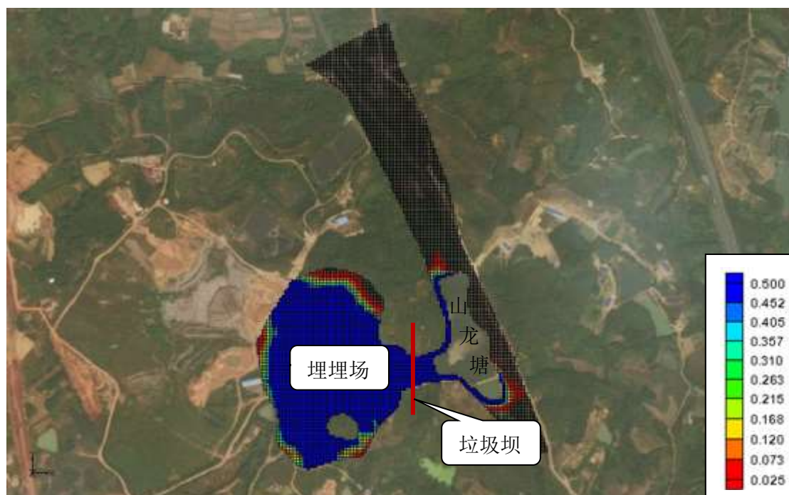
图 6.2-30 渗滤液渗露后 1000 天，第一层含水层氨氮浓度增量分布图
