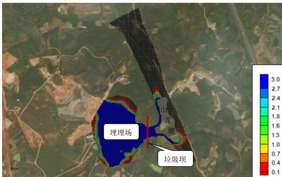
图 6.2-23 渗滤液渗露后 3650 天，第二层含水层 \text{COD}_{\text{Mn}} 浓度增量分布图
