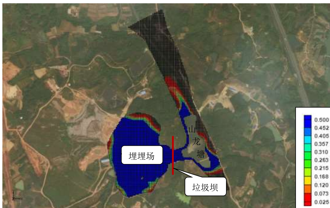
图 6.2-36 渗滤液渗露后 7300 天，第二层含水层氨氮浓度增量分布图 (8) 渗滤液渗漏对山龙塘水质的影响
