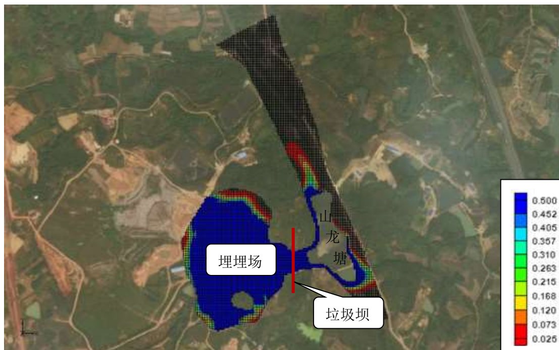
图 6.2-32 渗滤液渗露后 7300 天，第一层含水层氨氮浓度增量分布图
