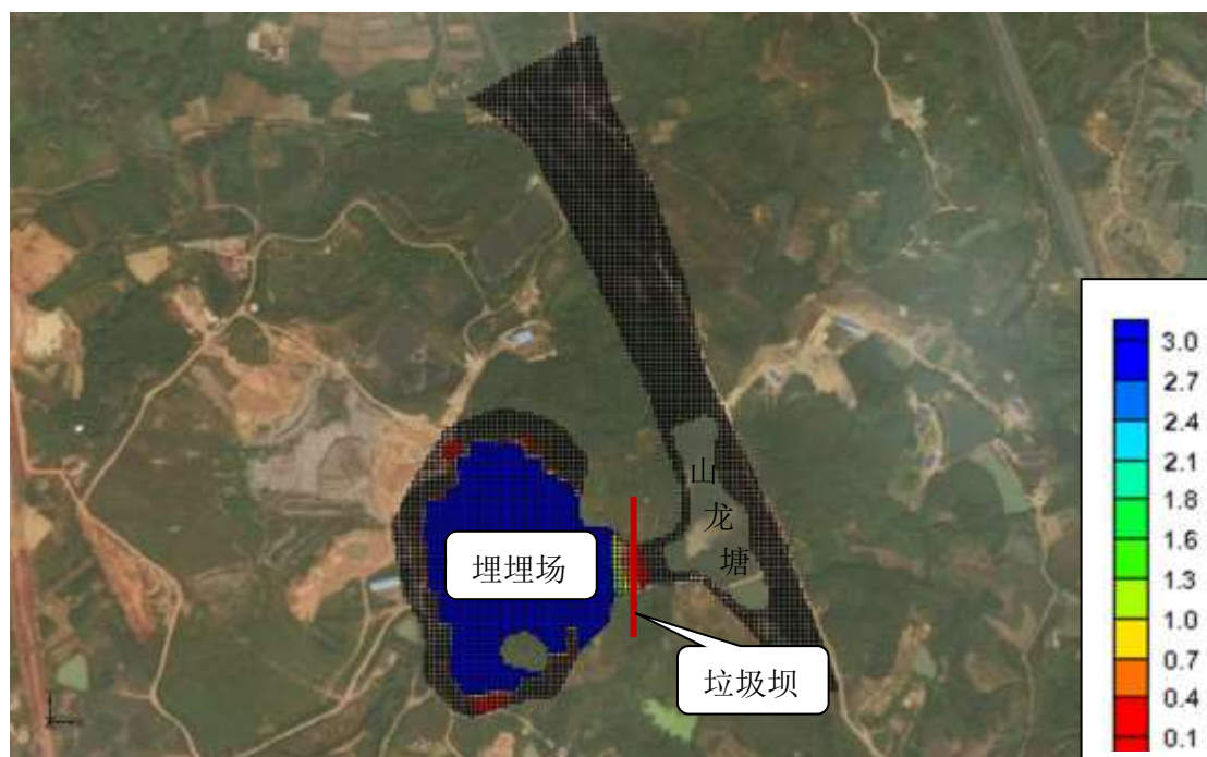
图 6.2-17 渗滤液渗露后 100 天，第一层含水层 \text{COD}_{\text{Mn}} 浓度增量分布图
