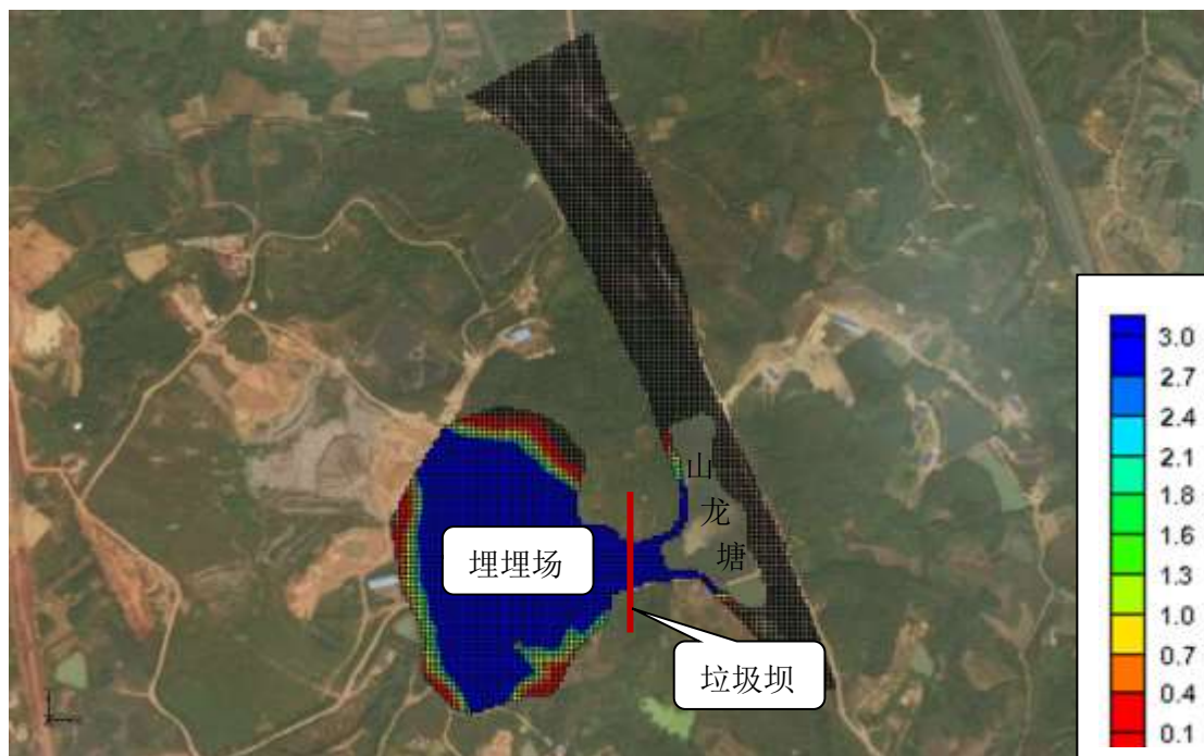
图 6.2-22 渗滤液渗露后 1000 天，第二层含水层 \text{COD}_{\text{Mn}} 浓度增量分布图
