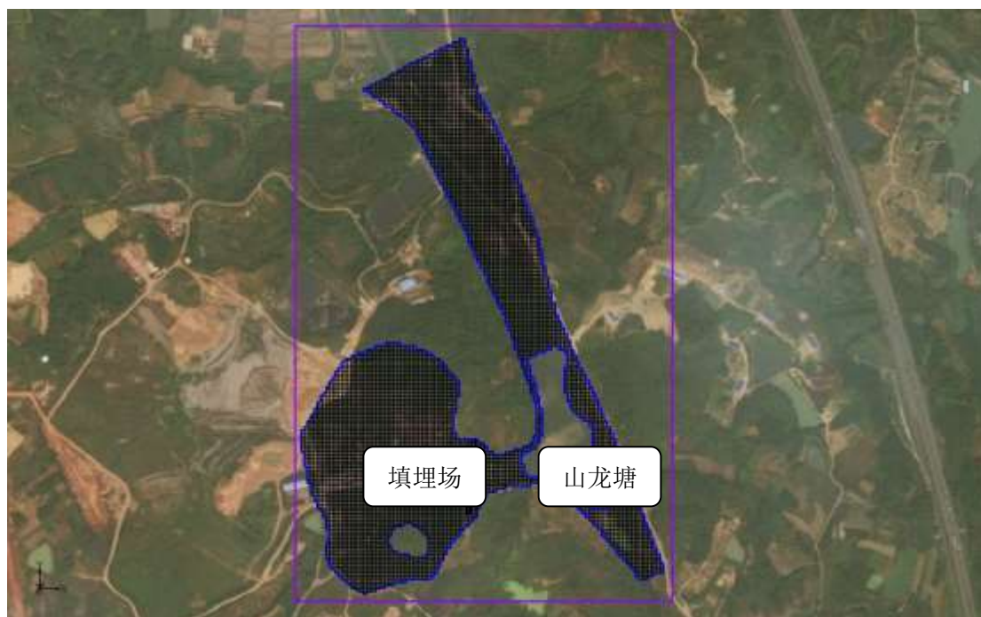
图 6.2-6 计算区域和第一含水层计算网格（蓝线为模拟计算区域边界）
