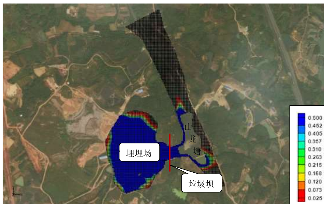
图 6.2-35 渗滤液渗露后 3650 天，第二层含水层氨氮浓度增量分布图
