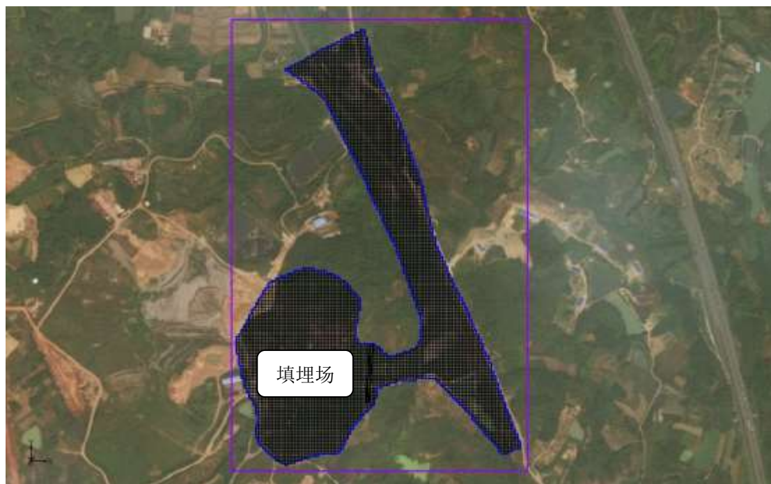
图 6.2-7 计算区域和第四含水层计算网格（蓝线为模拟计算区域边界）
