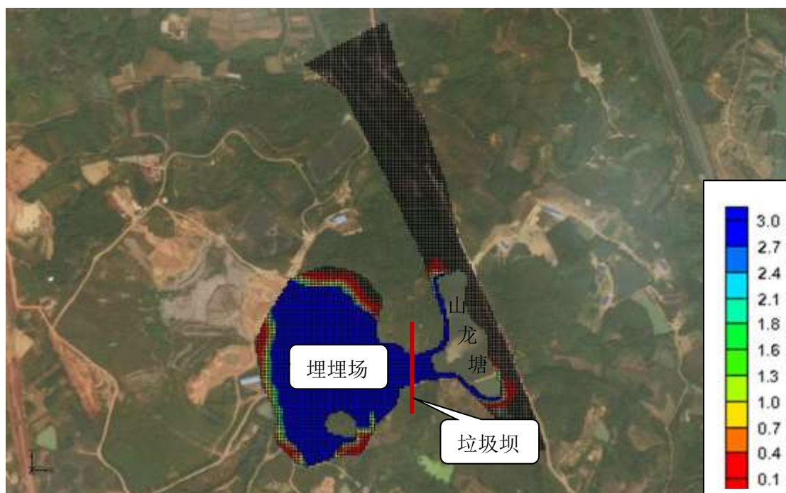
图 6.2-19 渗滤液渗露后 3650 天，第一层含水层 \text{COD}_{\text{Mn}} 浓度增量分布图
