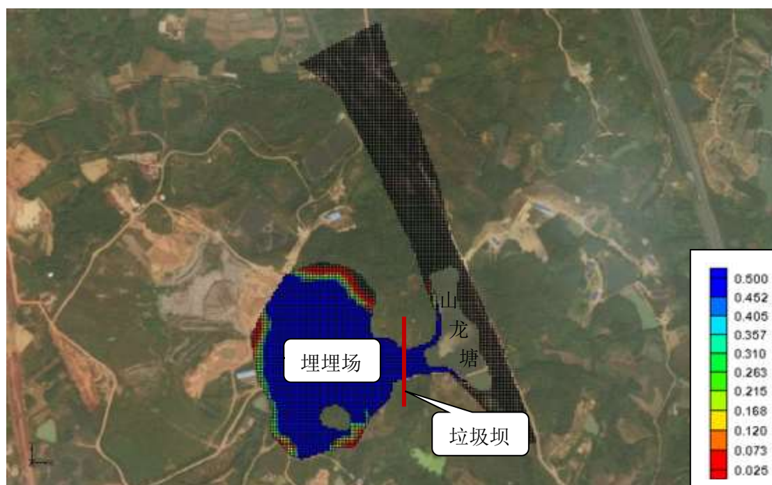
图 6.2-31 渗滤液渗露后 3650 天，第一层含水层氨氮浓度增量分布图
